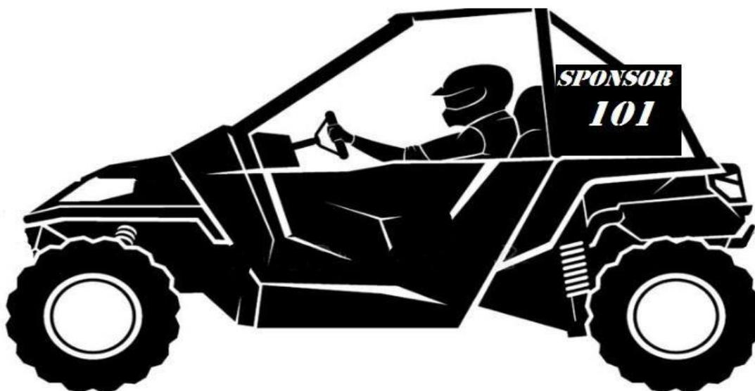
Per permettere l'applicazione dei numeri sulle vetture aperte, è autorizzato predisporre due porta numero, uno per ciascuno lato della vettura, fissati alle controventature del Roll-Bar, senza nessuna foratura, mediante fascette metalliche e non, fatti in materiale plastico tipo policarbonato e similari, che non abbiano spigoli vivi e/o bordi taglienti.
